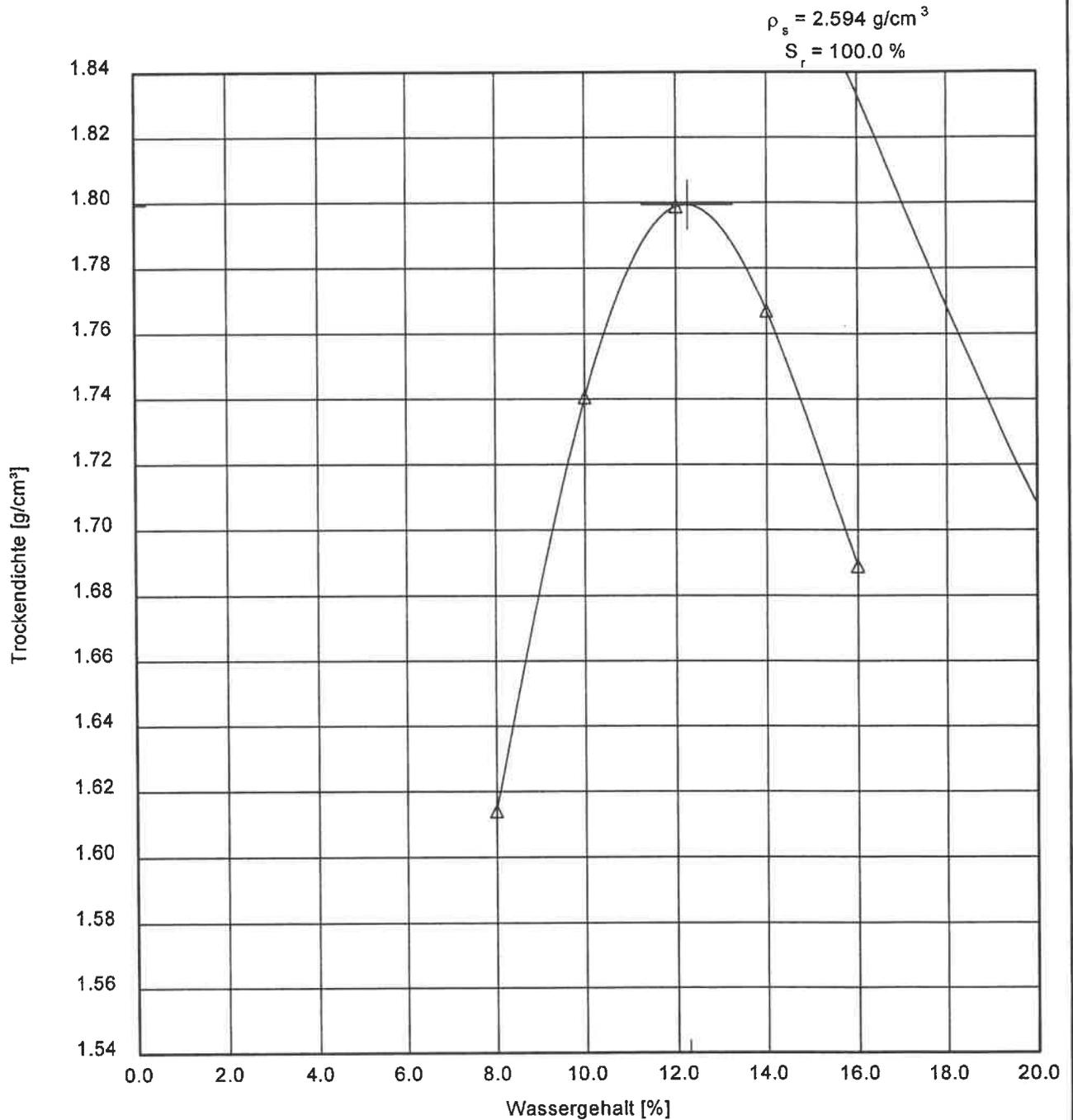
100 % der Proctordichte  $\rho_{Pr} = 1.799 \text{ g/cm}^3$
